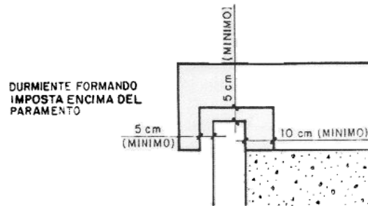
Fig. 8.7. UNION DEL DURMIENTE CON EL PARAMENTO
