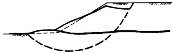
Fig. 12.5. ROTURA CIRCULAR CORTANDO EL REFUERZO
