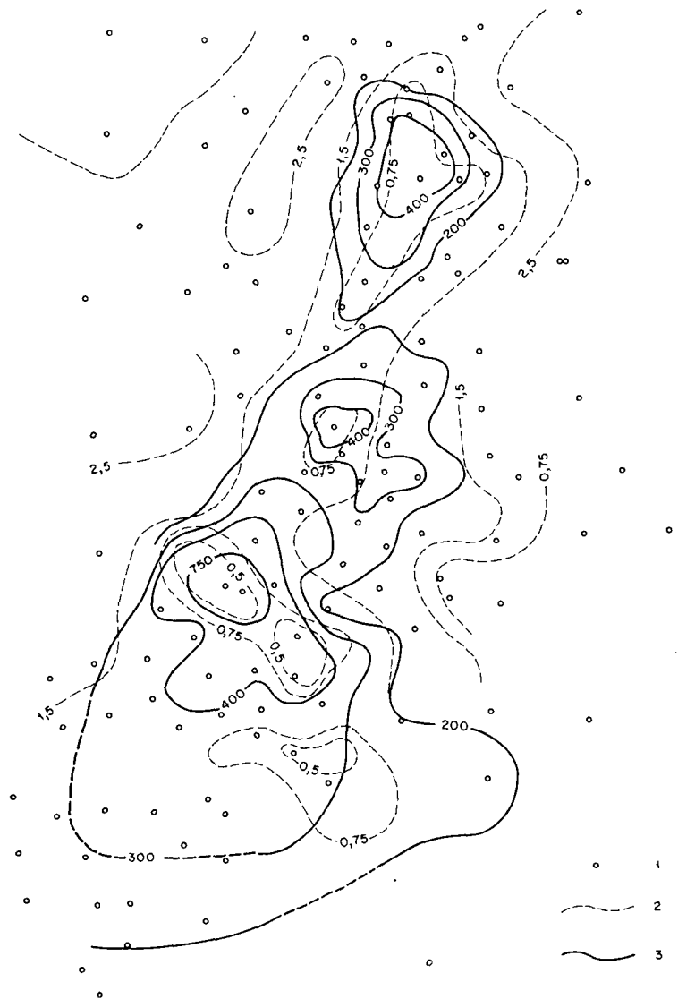
Fig. 290.—Región Don-Medveditsa. Plano de abcisas y ordenadas \bar{\rho}_{max} . (según B. L. Gurevich). 1.—Punto de SEV; 2.—Isolíneas de abcisas de \bar{\rho}_{max} (km); 3.—Isolíneas de ordenadas de \bar{\rho}_{max} ( \Omega m)
