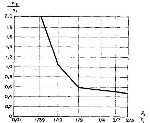
Fig. 206.—Curvas de SEV de tipo Q ( \rho_3 = 0 ). Valores máximos de h_2/h_1 para los que aún no se refleja la segunda capa en la curva de SEV.
