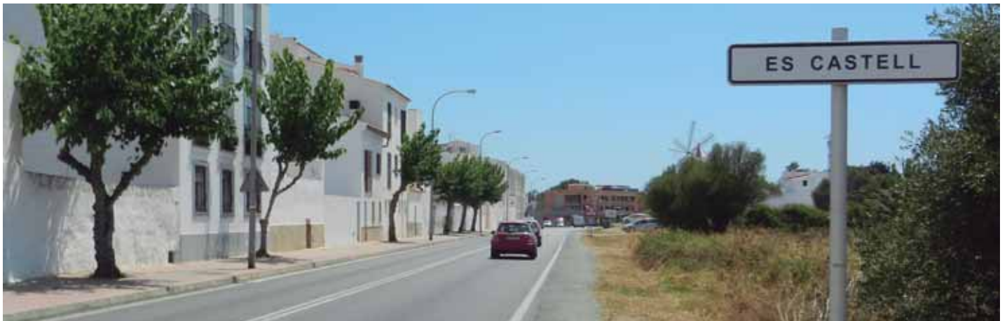
Formato no reglamentario de entrada a población.
