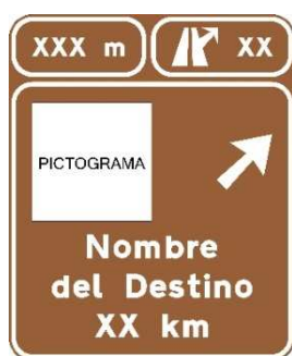
Cartel de preseñalización en autopista o autovía
