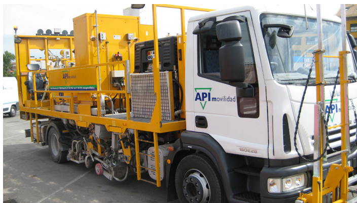
FIGURA 6.2.3. MÁQUINA MIXTA PARA PULVERIZACIÓN Y EXTRUSIÓN DE ALTO RENDIMIENTO
