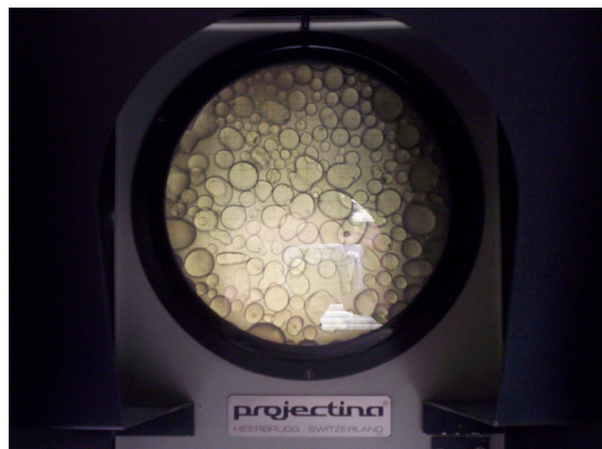
FIGURA 2.3.17. DETERMINACIÓN DEL % DE MICROESFERAS DE VIDRIO DEFECTUOSAS.
