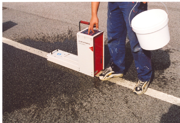
FIGURA 2.3.21. MEDIDA DE LA RETRORREFLEXIÓN EN HÚMEDO.
