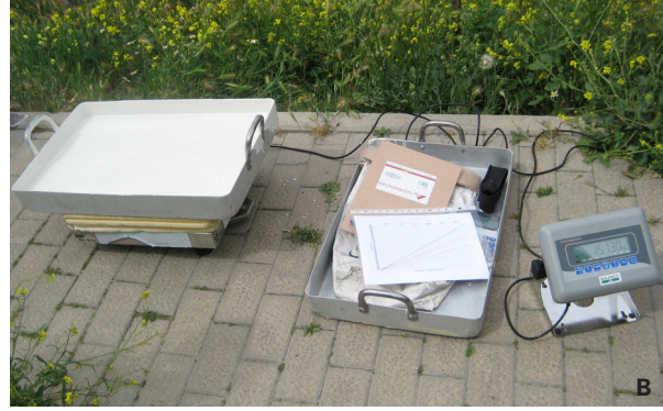
FIGURA 5.2.1. PROCESO DE AJUSTE EN OBRA. A) TOMA DE MUESTRA DEL MATERIAL SUMINISTRADO POR LA MÁQUINA EN LAS CONDICIONES DE TRABAJO PREVIAMENTE ESTABLECIDAS. B) PESADA DE LA MUESTRA TOMADA.
