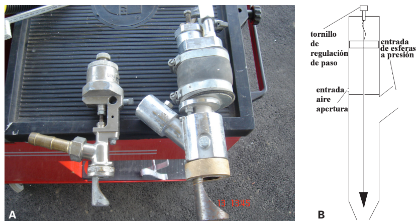
FIGURA 6.4.3. DISTRIBUIDOR DE MICROESFERAS A PRESIÓN. A) PISTOLA REAL, B) ESQUEMA DE FUNCIONAMIENTO.
