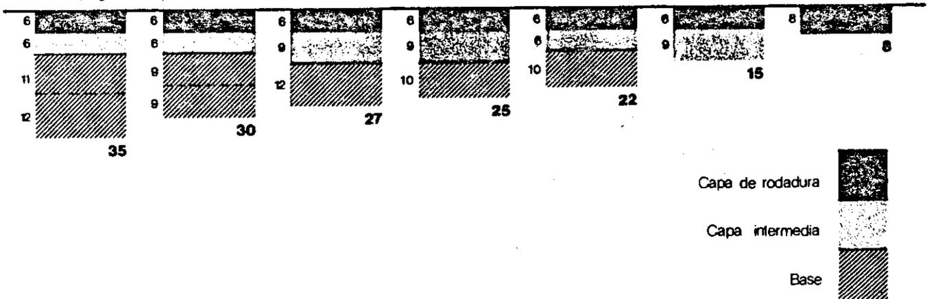
En las capas de mezclas bituminosas empleadas en el arcén exterior no serán exigibles las prescripciones relativas a pulimento acelerado en el árido grueso; asimismo se procurará emplear tamaños máximos de árido menores que en la calzada, y los menores huecos en mezcla dentro de la gama permitida, a fin de lograr una mayor impermeabilidad.
