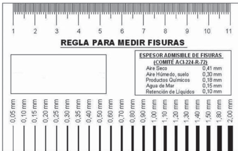
FIGURA 344. FISURÓMETRO DE BOLSILLO.
