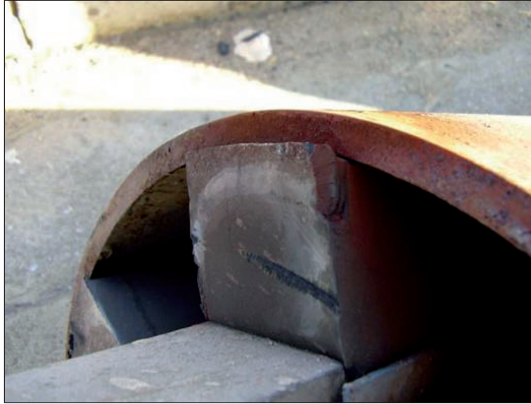
FIGURA 222. PISTONES DE ELASTÓMEROS DISTORSIONADOS CON EXCESO DE COMPRESIÓN.
