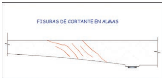
FIGURAS 335 Y 336. FISURACIÓN POR CORTANTE EN VIGA DE HORMIGÓN.
