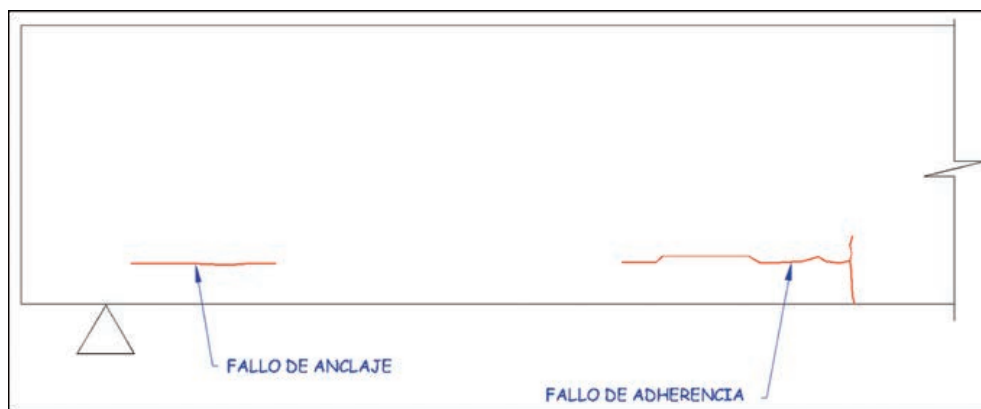
FIGURA 143. FISURAS POR FALLO DE ADHERENCIA-ANCLAJE.
