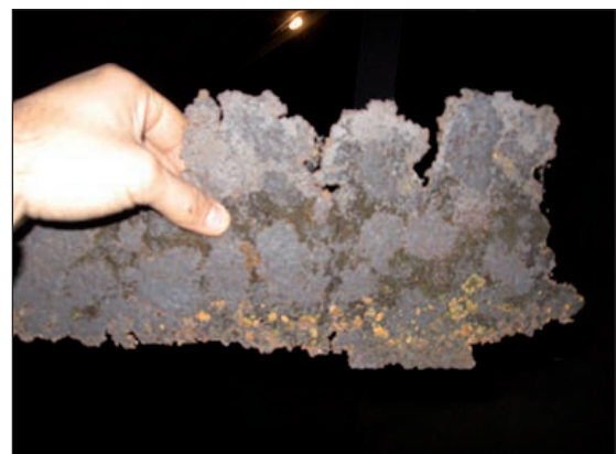
FIGURAS 170 Y 171. DETALLE DE CORROSIÓN EN EL INTERIOR DE UN CAJÓN METÁLICO.
