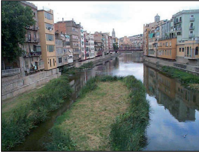
FIGURA 2.16.1. BARRA INTERMEDIA DENTRO DE UN CAUCE.
