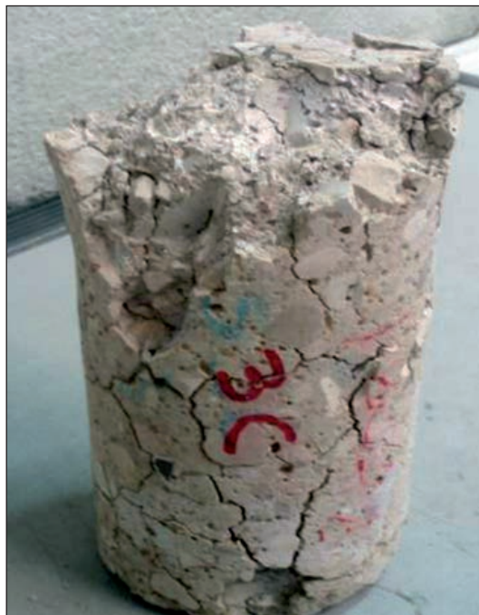
FIGURA 302. ASPECTO DE UNA PROBETA DE HORMIGÓN TRAS UN ENSAYO ACCELERADO DE ATAQUE POR SULFATOS.
