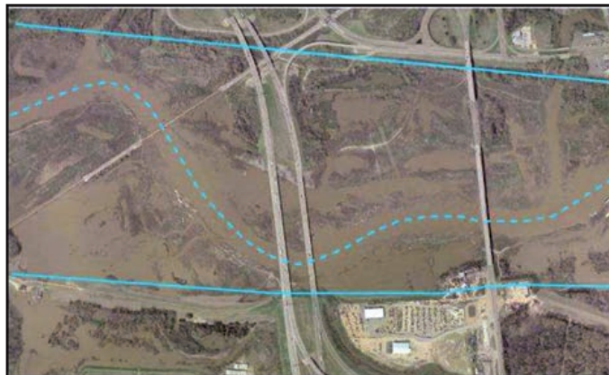
FIGURA 2.4.3. CAUCE EN AGUAS ALTAS (DELIMITADO POR LAS LÍNEAS CONTINUAS) Y EN AGUAS BAJAS (INDICADO POR LA LÍNEA DISCONTINUA).
