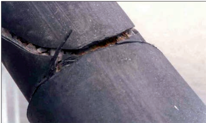
FIGURAS 204 Y 205. FISURACIÓN DE LA VAINA DE POLIETILENO DEL RECUBRIMIENTO. SE PUEDE OBSERVAR EL MORTERO DEL INTERIOR Y MANCHAS DE ÓXIDO, QUE PODRÍAN SER INDICATIVAS DE CORROSIÓN EN LOS ALAMBRES.
