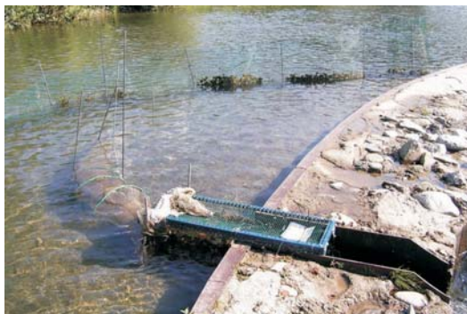
Figura 4.23. Seguimiento con nasa de un dispositivo de paso para peces, en este caso situado en un azud. Foto: Quim Pou-CERM.
