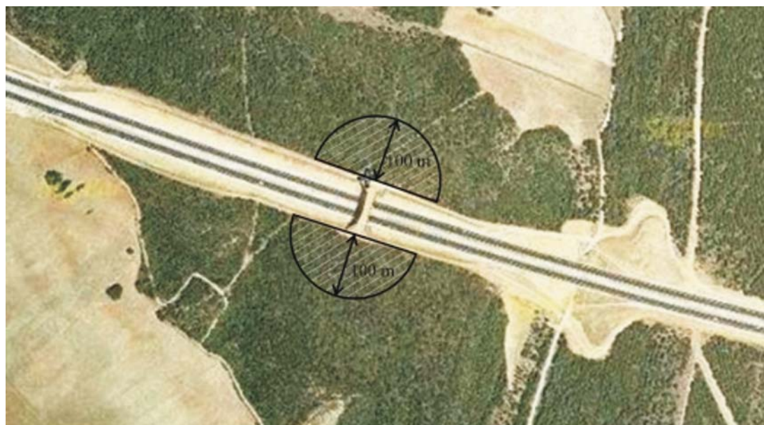
Figura 4.8. Área sujeta a control de los hábitats adyacentes a una estructura. Ejemplo práctico: paso superior específico (pk 66+500) en la autovía A-231 en la provincia de Palencia. Base cartográfica: SigPac, Ministerio de Agricultura, Pesca y Alimentación, España.
