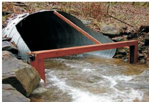
Figura 4.24. Estructura para la detección de transmisores aplicados a peces. Foto: Jorge García Molinos.
