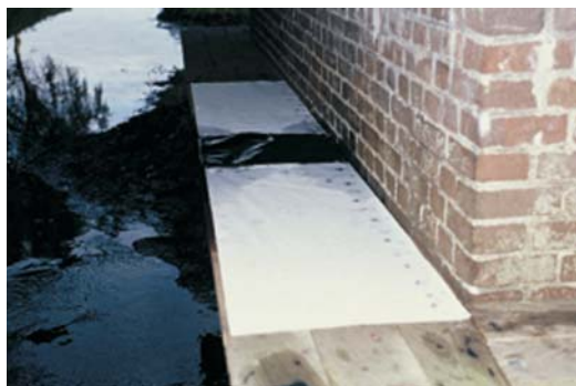
Figura 4.14. Lechos de tinta situados en una plataforma para facilitar el paso de fauna a través de un drenaje Foto: Hans Bekker.
