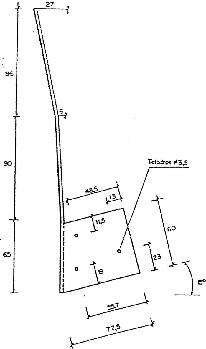
CHAPA DE ACERO GALVANIZADO DE 3mm.
